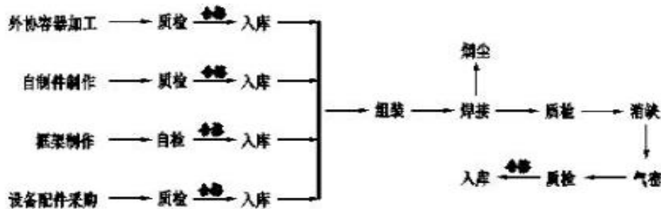
图3.1-4 制氢附属框架及纯化框架生产工艺流程
