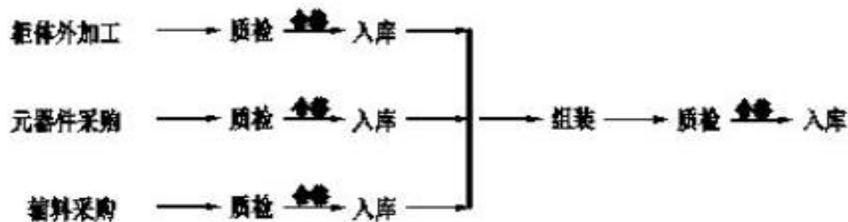
图3.1-5 电气柜（包括配电柜、PLC柜、电磁阀箱等）生产工艺流程
